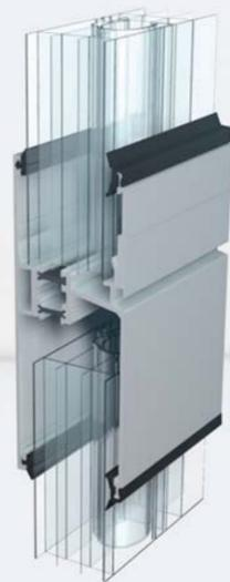
Bei Fassadenhöhen über 6 Meter werden zwei oder mehrere Nut-Feder-Paneele über Kopplungsprofile (Bild links als thermisch getrennt) miteinander Verbunden. Ein Einsatzbeispiel befindet sich auf dem Deckblatt. Lüftungs- und RWA-Systeme können mit H-Sprossen in die Fassade integriert werden.
