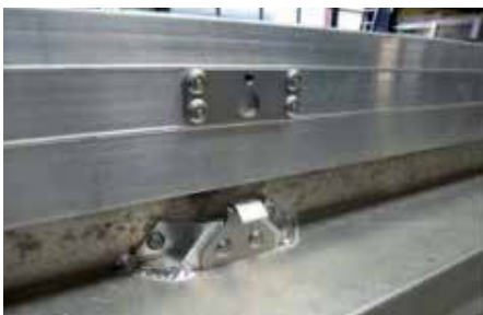
Aufnahmepunkte für das Riegelblech
