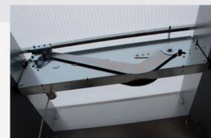
Traverse mit 48 V Antrieb
