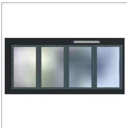
Lamellenfenster stets vertikal oder horizontal transportieren! Darauf achten, dass die Lamellen beim Transport stets geschlossen sind! Das Anheben an einzelnen Lamellen ist unzulässig!
