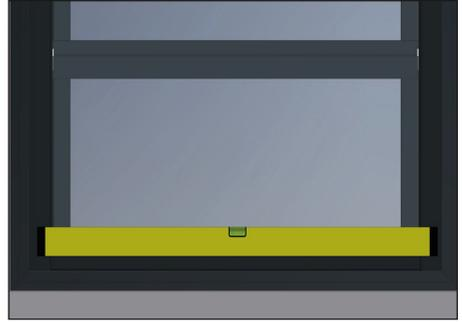
Lamellenfenster in Einbauöffnung heben und exakt vertikal sowie horizontal ausrichten
