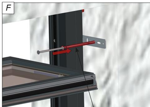
Kernlochbohrung (8mm) bohren und Lamellenfenster mit Dübeln fixieren.
